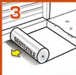
3 Lay the geotextile membrane.
