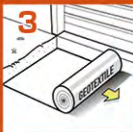
3 Lay the geotextile membrane.
