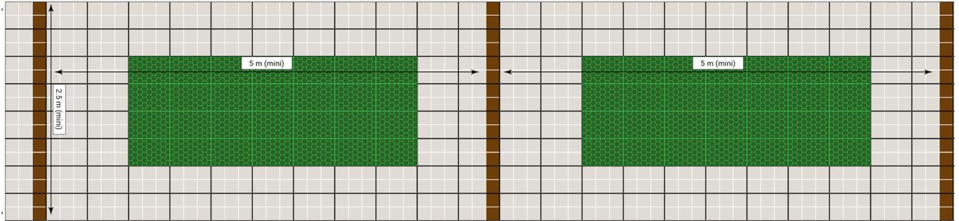
Selon la norme NF P91-100, les dimensions minimum d'une place de parking sont 2.5 x 5 m.
