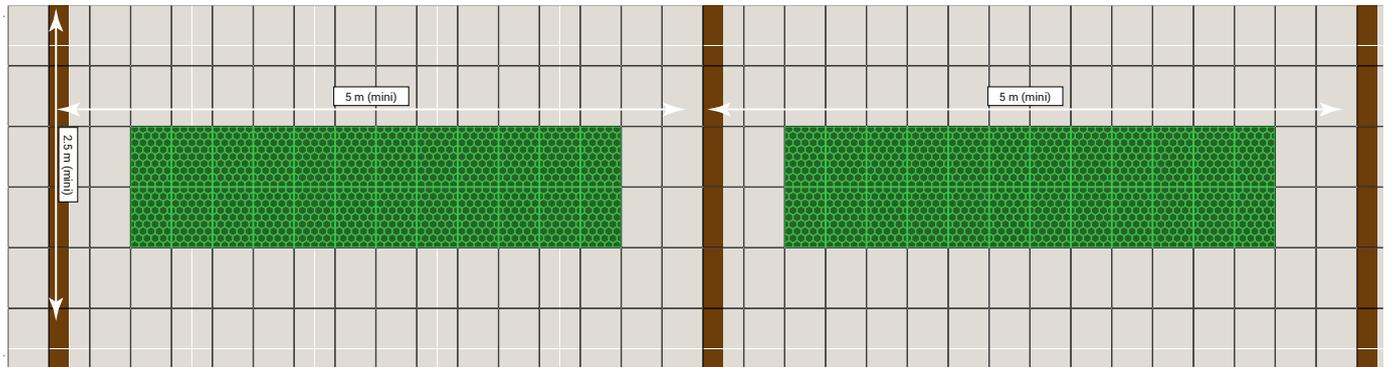
Selon la norme NF P91-100, les dimensions minimum d'une place de parking sont 2.5 x 5 m.
