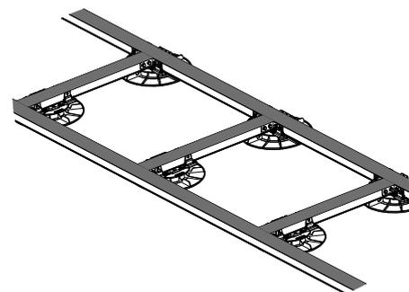
*NB : le couple de serrage à appliquer sur les vis structure est de  $2.5 \pm 0.5$  Nm . Ce qui correspond normalement à la position 8 sur la bague de réglage d'une visseuse 18 volts de 20 positions.*
