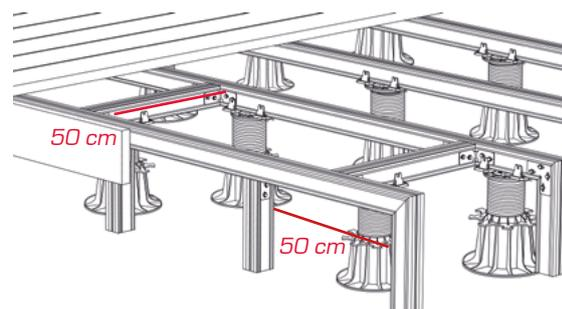
\* Etréssillon : pièce placée entre les lambourdes de la structure pour la consolider.
