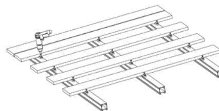
Dans le cas d'aboutage de lames, il est préconisé d'effectuer un double lambourdage : une lambourde pour la fin de la 1ère lame et une lambourde pour le départ de la lame qui suit (voir schéma).
