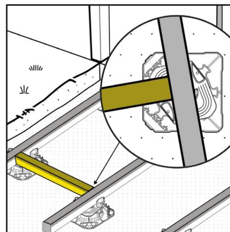
› Lors d'un lambourdage simple, nous préconisons la pose d'étrésillons afin de rigidifier l'ensemble de la structure et garantir un entraxe constant entre les lambourdes.
