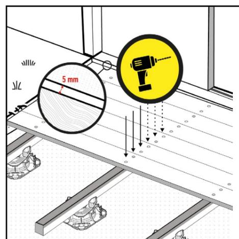
› Visser au minimum à 15 mm du bord de la lame (a).
